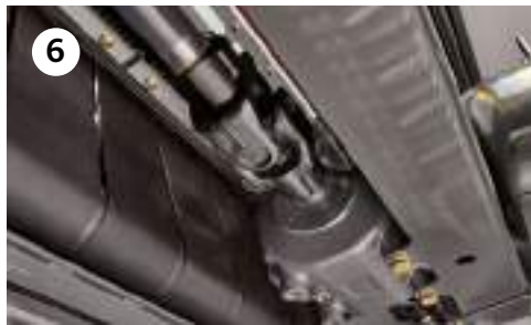
Schwere Kardanwellen/Kreuzgelenke in Antriebsachsen
