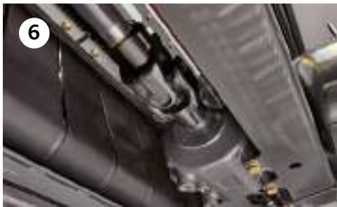
Schwere Kardanwellen/Kreuzgelenke in Antriebsachsen
