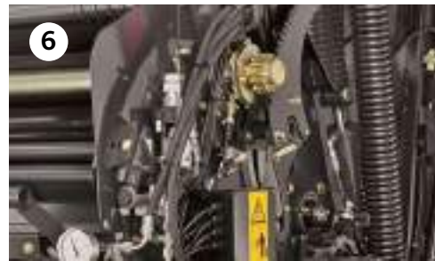
Proportionalventil für Dichteregelung von der Fahrerkabine aus
