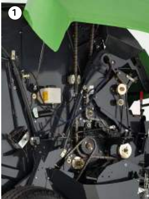
Robuster Antrieb mit hochwertigen IWIS-Ketten
