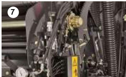
Proportionalventil für Dichteregelung von der Fahrerkabine aus
