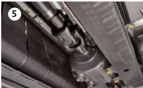
Schwere Kardanwellen/Kreuzgelenke in Antriebsachsen
