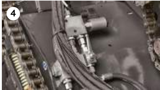
Separate Messerabschaltung/Absenkung des Schneidbodens vom Fahrersitz aus
