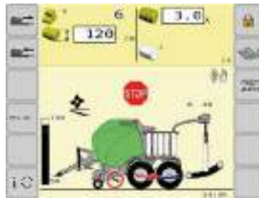
Vollautomatisches Rotor-DEBLOCK-System (nur VM BP)
