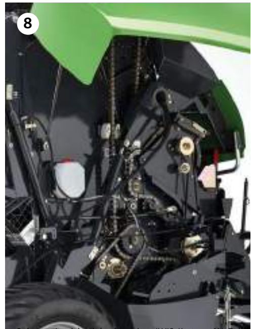
Robuster Antrieb mit hochwertigen TWIS-Ketten + 1¼-Zoll- 20HB-Hauptantriebswelle mit Hartchromstiften
