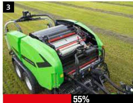
Die Anzahl der Schichten kann über das ISOBUS-Terminal ganz einfach eingestellt werden. Durch die intensive Vorstreckung lassen sich 30 % der Folienkosten einsparen, bei einer Folienbindung mit vorgestreckter Folie sogar noch mehr
