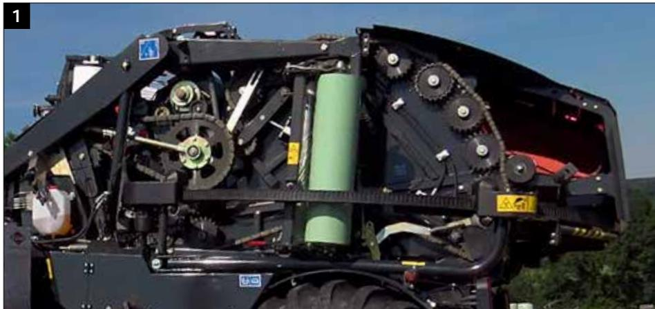
1 Robuster Antrieb mit hochwertigen IWIS-Ketten
