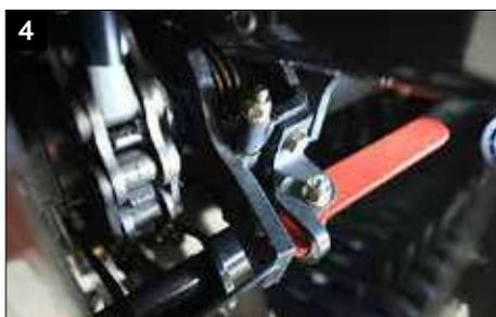
4 Mechanische Rotorentkopplung
