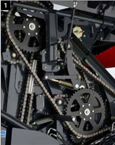
1 Robuster Antrieb mit hochwertigen IWIS-Ketten
