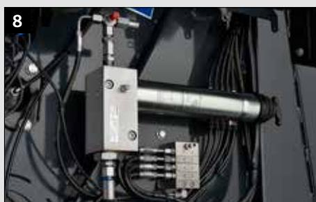
Serienmäßiges automatisches Schmieresystem für die Walzenlager
