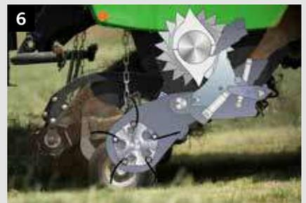
6 Nach dem Schneidboden wird auch der Gegenmesserkeilm wieder in Position gefahren. Durch die getrennte Betätigung von Schneidboden und Messer läuft der Vorgang schnell und sicher ab
