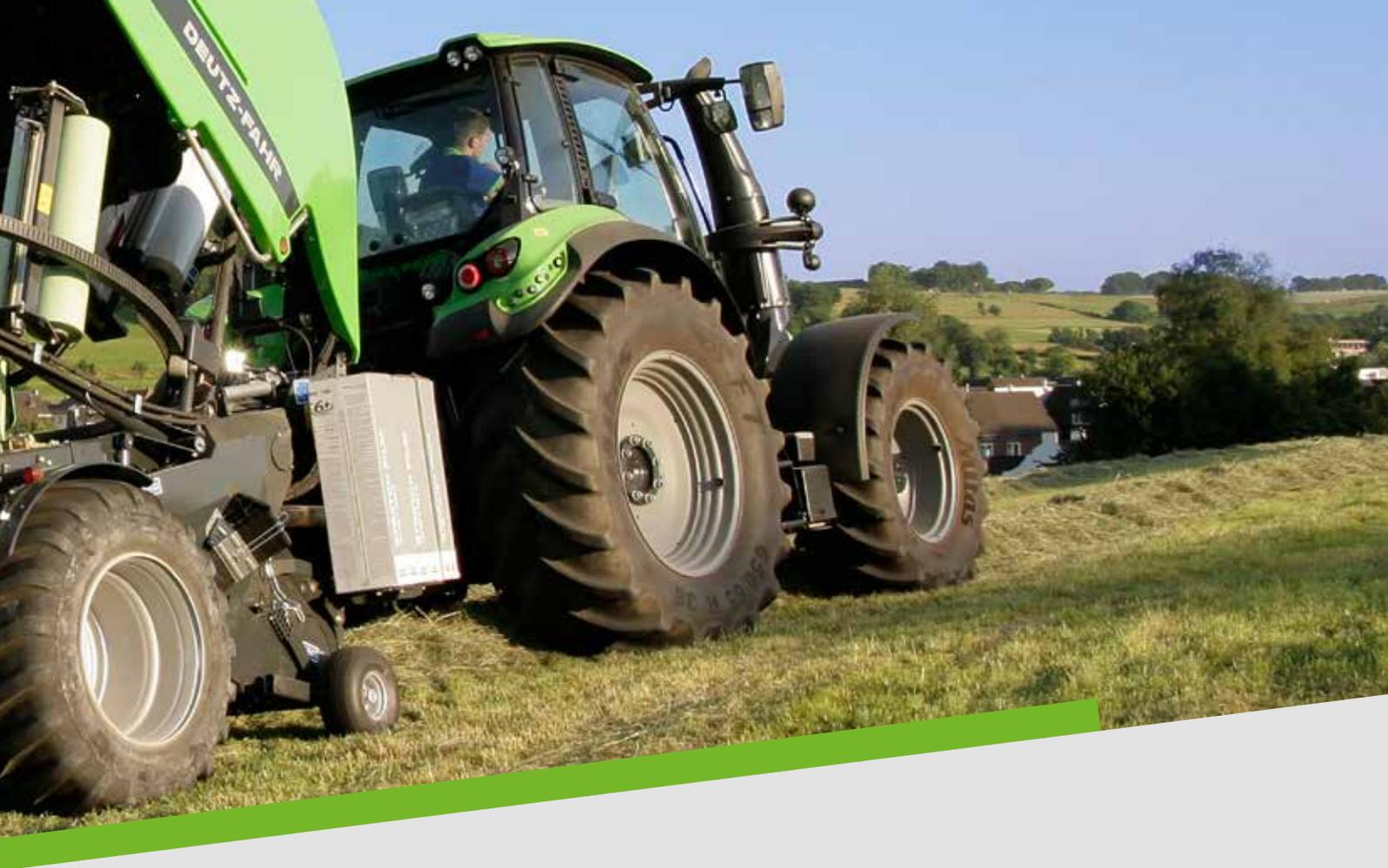
IntelliWrap ist auch als 3D-Wickler einsetzbar. Dabei handelt es sich um eine intelligente, innovative Art der Folienwicklung. Entscheidend dabei ist, dass die Folienmenge möglichst gleichmäßig und effizient auf der gesamten Ballenfläche verteilt wird. Da die Mantelfläche zuerst umwickelt wird, wird mehr Luft aus den Ballen entfernt und ihre Form bleibt auch bei langer Lagerung stabil.
