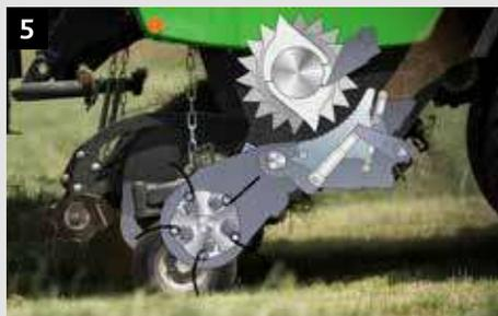
5 Sobald die gemessene Rotordrehzahl wieder dem Sollwert entspricht, wird zunächst der Schneidboden in Position gebracht. Dank der Automatik geht das sehr schnell vonstatten
