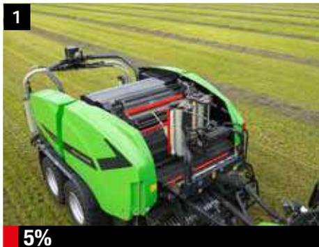
Zu Beginn des Bindevorgangs befinden sich die Vorstrecker in aufrechter Position. So wird der Ballen direkt mit 2 Folienbahnen fest eingestreckt
