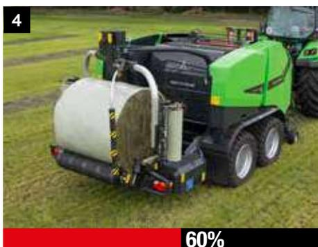
Wenn der Ballen die Presskammer verlässt, sind bereits 60 % seiner Fläche mit Stretchfolie bedeckt. Eine reguläre Folie, deren Schichten aneinander kleben, ist die Grundvoraussetzung für einen perfekt luftdicht verschlossenen Ballen. Die Stretchfolie auf der Mantelfläche des Ballens presst diesen zusammen und die zylindrische Form ermöglicht eine bequeme Lagerung
