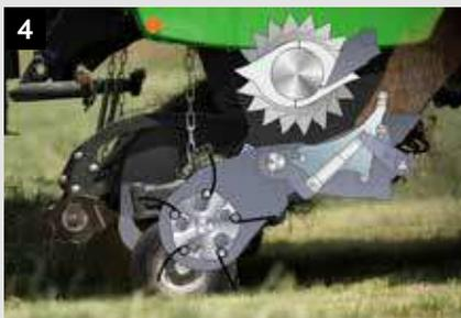
4 Während der Arbeit wird die Rotordrehzahl kontinuierlich überwacht. An der Rotorbewegung erkennt das System, dass die Aufnahme wieder frei ist, und löst den nächsten Schritt im Prozess aus
