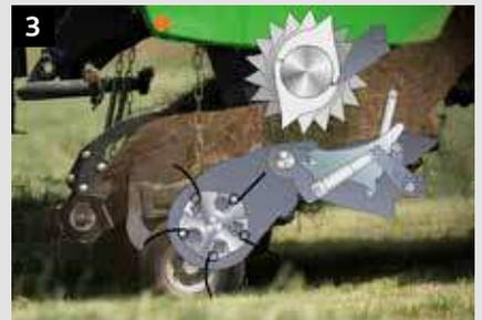
3 Nach dem Absenken von Gegenmesserkeilm und Schneidboden kann der Fahrer die Zapfwelle wieder einschalten. Da der Schneidboden abgesenkt ist, lässt sich das angestaute Pressgut jetzt der Maschine zuführen
