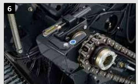
6 Serienmäßige hydraulische Rotorkopplung
