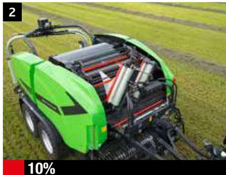
Anschließend werden die Vorstrecker in eine waagerechte Position gebracht. Da zwei Vorstrecker im Einsatz sind, ist nach etwa einer halben Drehung des Ballens die gesamte Breite abgedeckt
