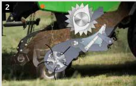
2 Nachdem die Zapfwelle vom Fahrer abgeschaltet wurde, beginnt die Presse automatisch mit der Staubereinigung. Zuerst werden die Messer aus dem Einzugskanal gezogen, anschließend wird der Schneidboden abgesenkt
