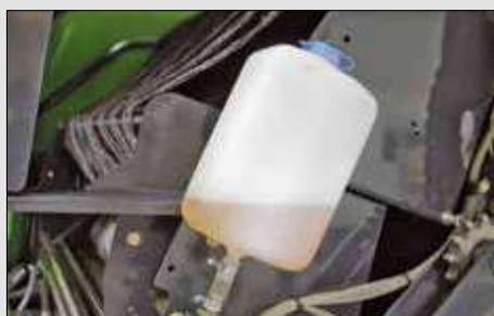
Damit die Ketten bei den Festkammerpressen lange Standzeiten erreichen, können die FIXMASTER-Pressen von DEUTZ-FAHR mit einer Kettenschmierung ausgerüstet werden, die einmal pro Bindezyklus auslöst.
