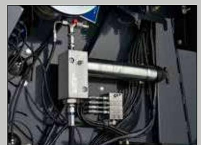
Automatisches Schmiersystem für die Walzenlager
