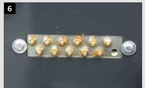
Zentral angeordnete Schmierbänke für die Walzenlager
