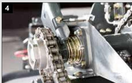
4 Mechanische Rotorentkopplung
