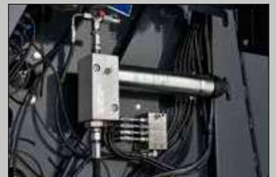
Automatisches Schmiersystem für die Walzenlager
