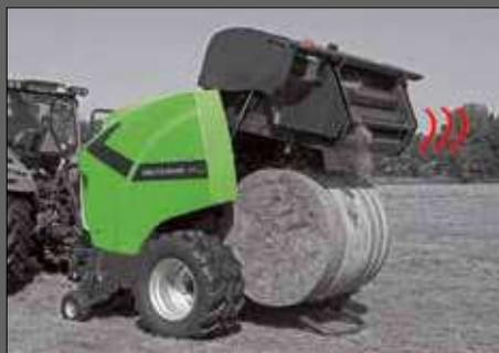
Die Heckklappe öffnet automatisch
