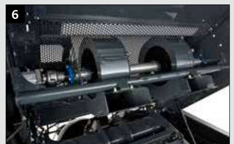
Turbinengebläse für Knoterreinigung
