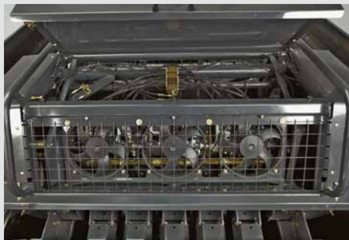
TWIN-STEP-MODELLE: ELEKTRISCHES REINIGUNGSGEBLÄSE
