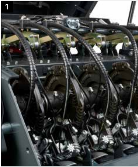
Doppelknotersystem mit serienmäßiger elektronischer Überwachung
