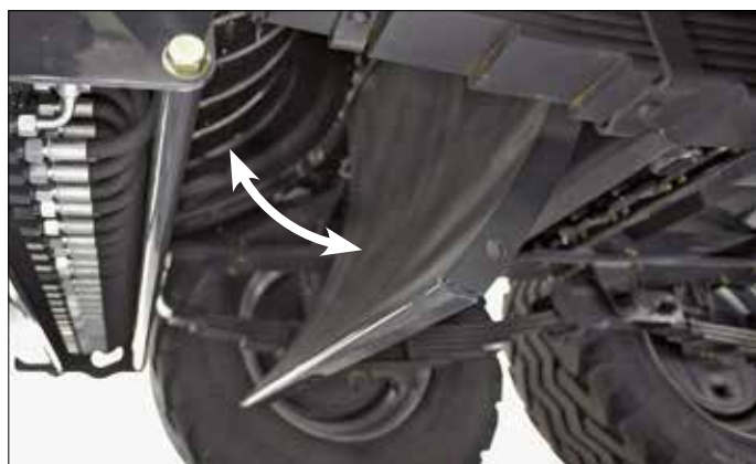
KONTROLLKLAPPE AN DER VORKAMMER
