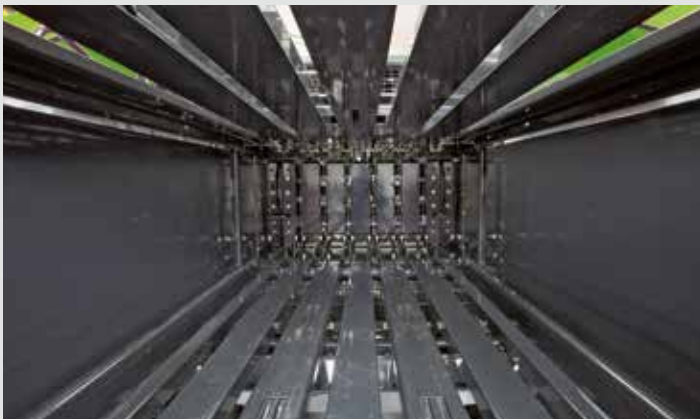
3.4 M (11'2") LANGER PRESSKANAL MIT RESTBALLENAUSWURF
