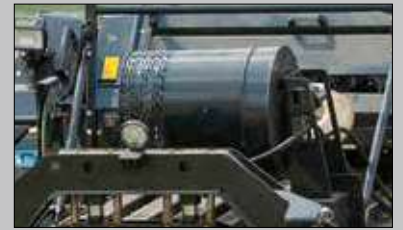
Hydraulischer Antrieb des Reinigungsgebläses (nur BM 5712)
